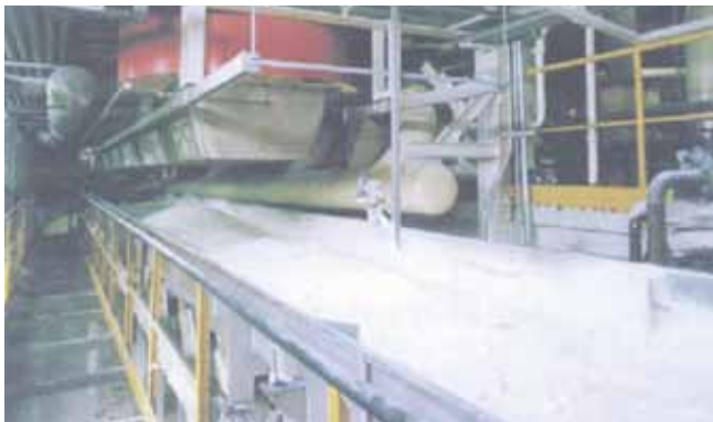
Descarga de las centrífugas de azúcar por el transportador de resonancia con masa compensada
