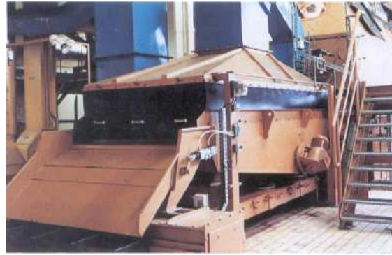
Refrigeradora de plataforma vibratoria para fluidificar los materiales a granel de cualquier clase
