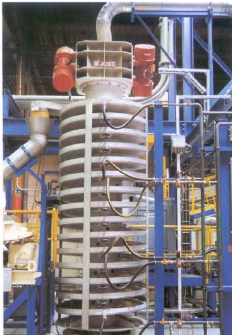
Elevador espiral con refrigeración con agua para un transporte vertical
