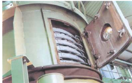
Secador de disco vibratorio con calentamiento a vapor indirecto
