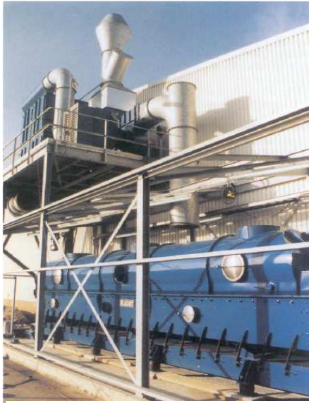
Secador de plataforma vibratoria para fluidificar los materiales a granel de cualquier clase
