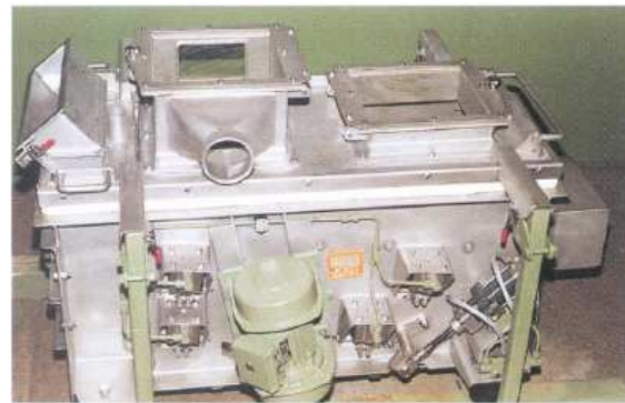
Criba tipo cajón con una fijación neumática a los marcos de las cribas para el reemplazo rápido de la cubierta de la criba
