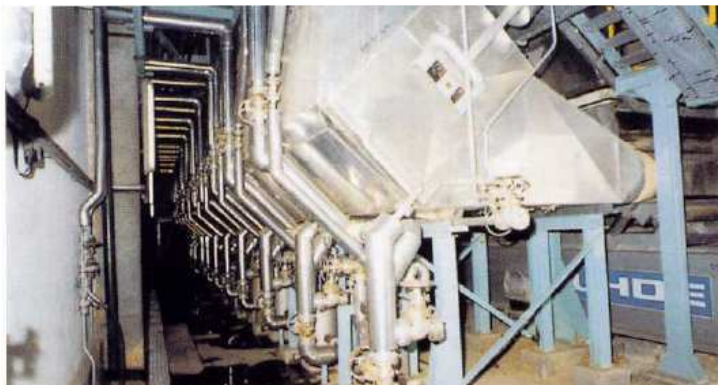
Secador para las pequeñas bolas de jebe no vulcanizado con una capacidad de 4500 kg/h
